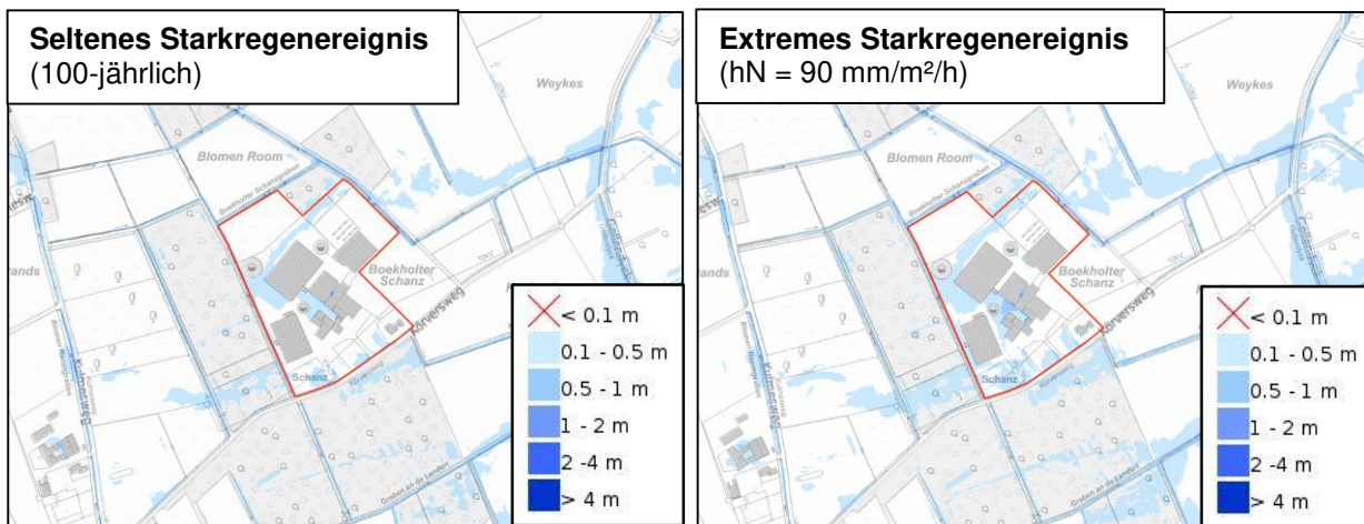
Abb. 2: Simulation von Starkregenereignissen – maximaler Wasserstand im Plangebiet (bei Betrachtung eines seltenen (links) und eines extremen (rechts) Starkregenereignisses Quelle: BKG - STARKREGEN NRW, eigene Darstellung - unmaßstäblich)
